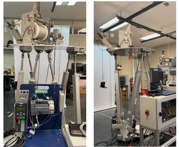
Prototipo de máquina de cubierta (grúa) sobre plataforma Stewart de simulación de movimientos oceánico
